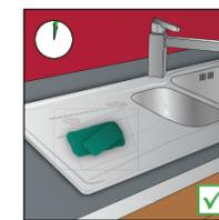
Dagelijks onderhoud: na gebruik van de spoelbak deze grondig spoelen en droog maken met een schone zachte doek om watervlekken etc. te verwijderen. Schoon water is genoeg voor dagelijks onderhoud, eventueel met toevoeging van een mild reinigingsmiddel (afwasmiddel). Gebruik geen schuurmiddelen zoals staalwol, schuurspons of een scherpe borstel, aangezien deze producten het oppervlak van roestvast staal kunnen aantasten.
